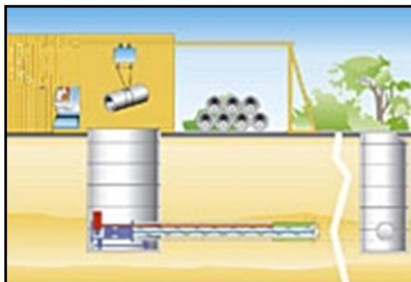
Grafički prikaz 2.4-10 Postupak mikrotuneliranja
