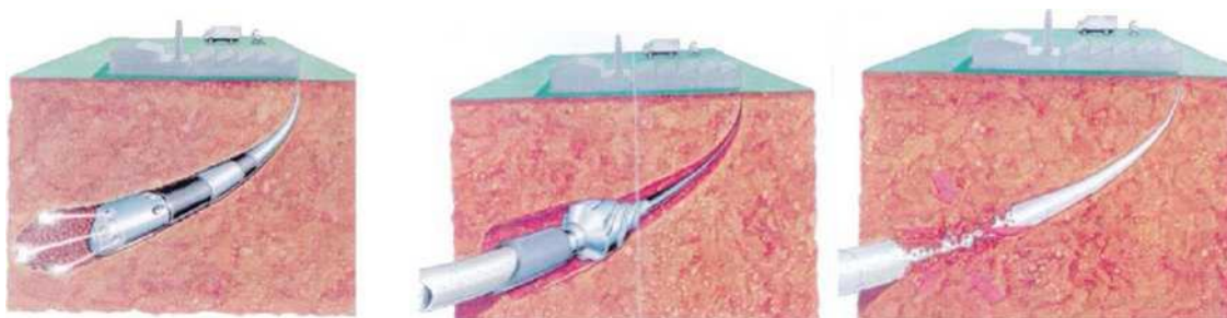
Grafički prikaz 2.4-12 Horizontalno usmjereno bušenje: 1. bušenje pilot bušotine; 2. proširivanje bušotine i uvlačenje cijevi; 3. uvučena cijev
