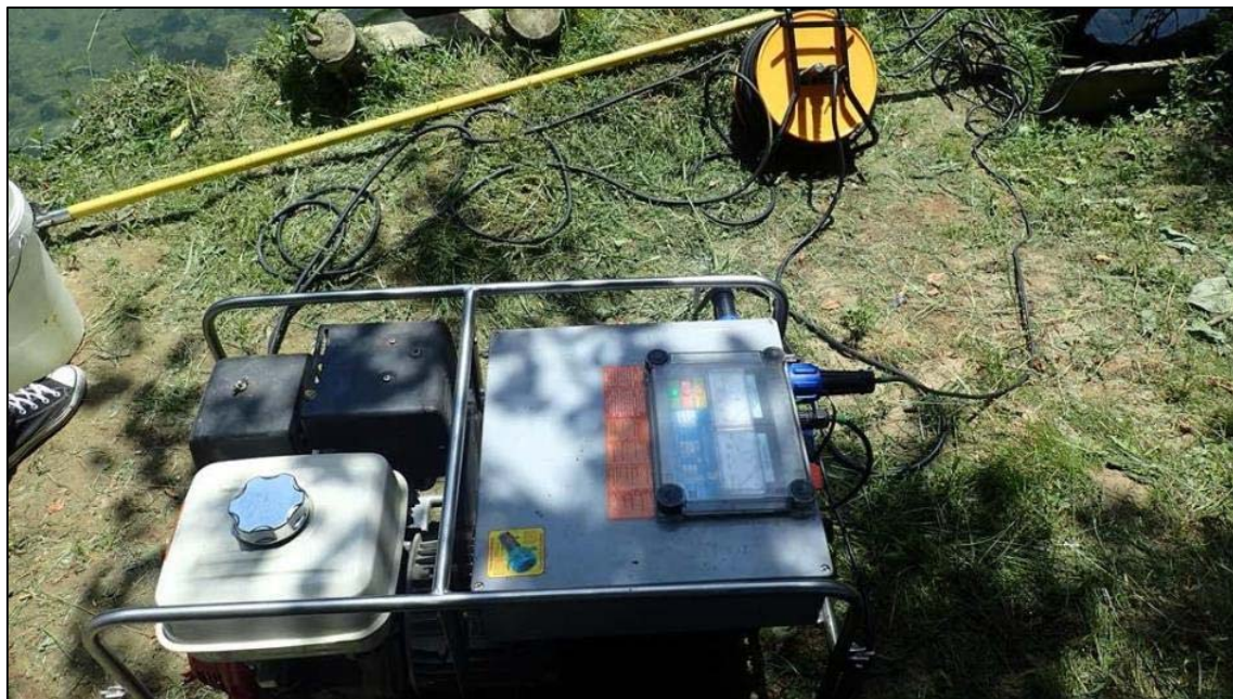
Slika 5-8: Stacionarni agregat Hans-Grassl EL63 II GI izlazne snage 6,5 kW
