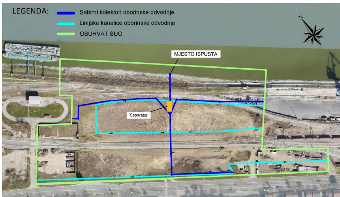
Slika 1-12 Shematski prikaz sabirnih kanala oborinske odvodnje
