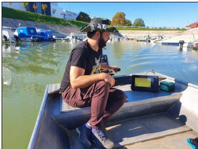
Slika 5-6: Korištenje side-scan multi beam sonara za snimanje dna
