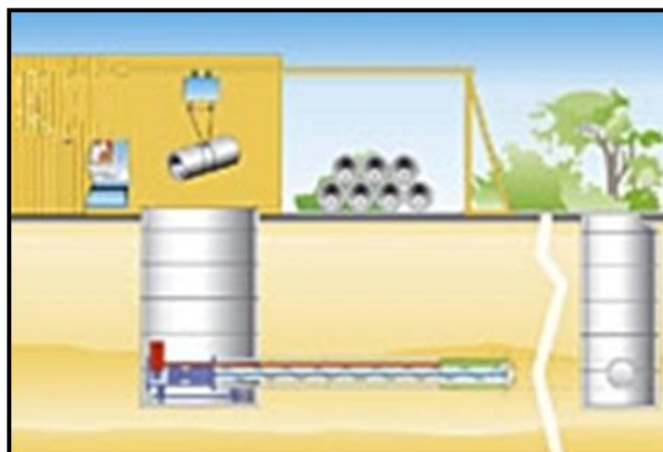
Grafički prikaz 2.4-11 Postupak mikrotuneliranja
